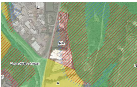
Figure 28 : zone AU en zone inconstructible (PPRn chute de pierres)
