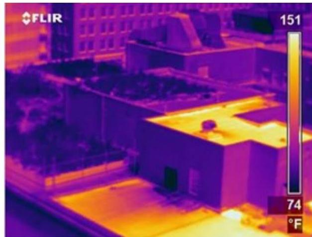
Un instrument d'imagerie thermique observe le toit végétalisé de l'hôtel de ville de Chicago et le toit d'un immeuble limitrophe non végétalisé. Le toit végétalisé de l'hôtel de ville de Chicago est jusqu'à 44°C (80°F) plus frais que le toit conventionnel voisin.
