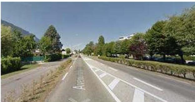
**Figure 116 : Surfaces imperméabilisées importantes et bande enherbée offrant des possibilités de désimpermeabilisation et de gestion in situ (avenue de Verdun)**
