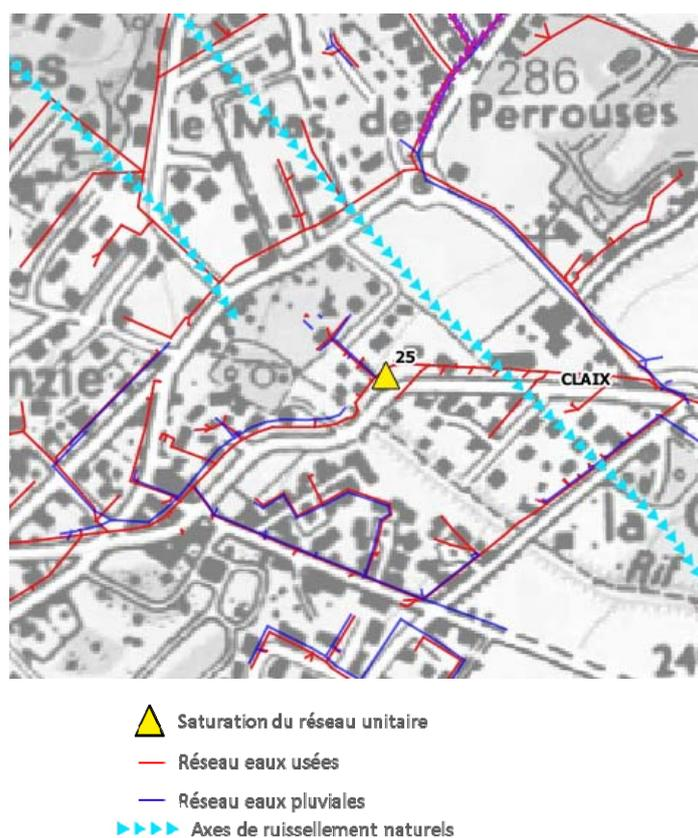
Figure 89 : Carte du fonctionnement hydrologique au niveau du dysfonctionnement n°25 (avenue de Belledonne)
