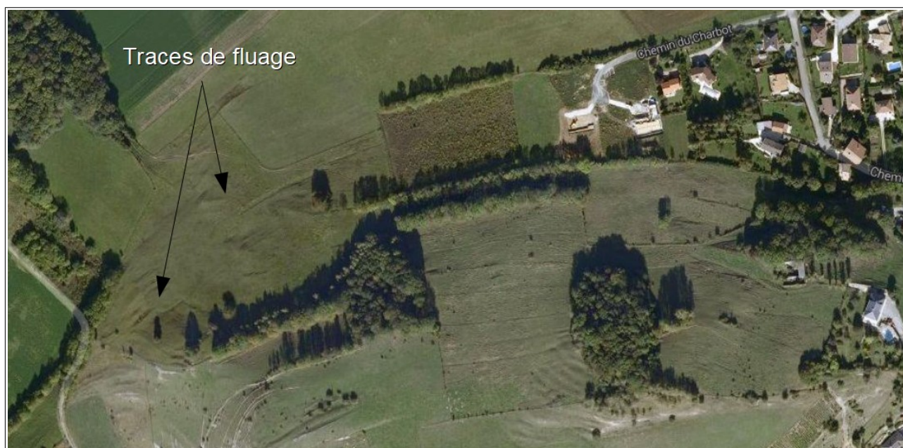
Photo 9: Le versant Nord de la colline du Plomb au Charbot présente des indices de fluages peu actifs en surface - Image Satellite
