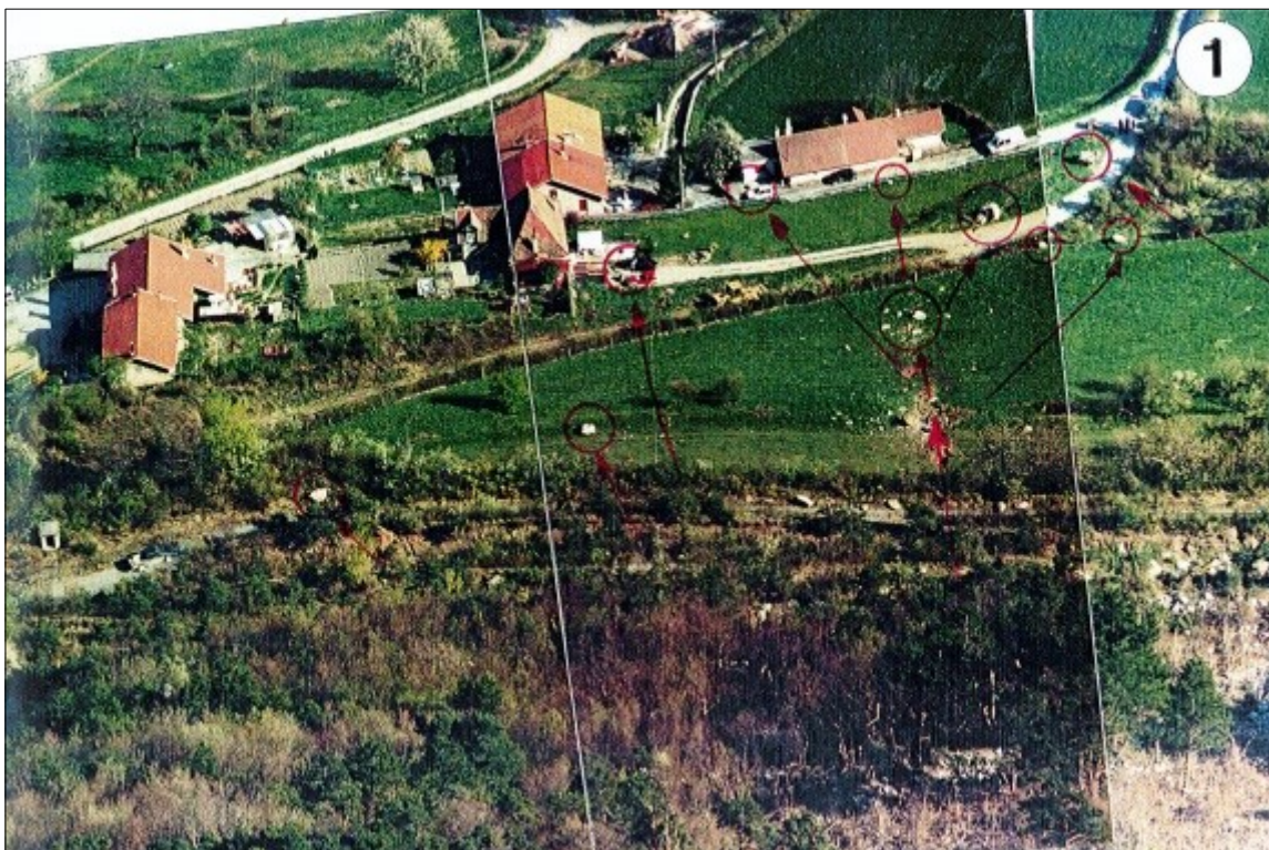
Photo 4 : Assemblage de photos du hameau de Champrond et des blocs éboulés en 1997 (source Mécanroc).
