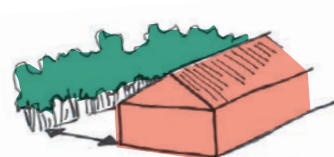
Le bâtiment s'implantera de manière à préserver un écart entre le bâtiment et la trame végétale au moins égal à la largeur du houppier d'un arbre adulte
