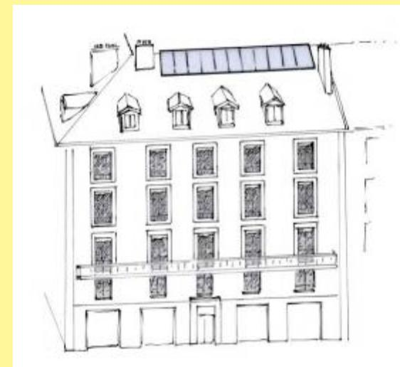
**✓** En fonction des ouvrages sur la toiture, les panneaux solaires peuvent être implantés au faîtage. Ils sont de préférence posés en superstructure – façon verrière sommitale. Au droit des panneaux, le faîtage est traité par les ouvrages rapportés.
