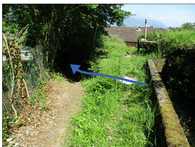
Photo 10: débordement du ruisseau de La Combe en cas d'obstruction de la buse
