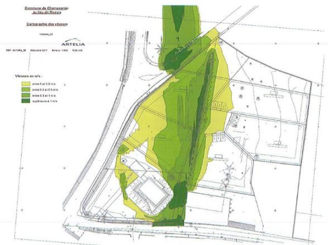
Figure 14 Carte des vitesses d'écoulement maximales pour détermination des aléas
