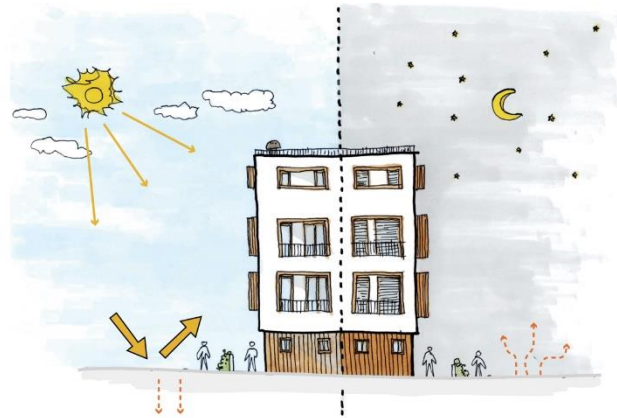
Surfaces à albédo élevé : la chaleur réfléchiée n'aggrave pas la sensation de chaleur
