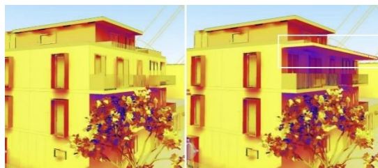
En violet sous cette casquette : 0h de réception solaire au solstice d'été et 9h au solstice d'hiver Maquette numérique solaire avec et sans casquette, Cerema
